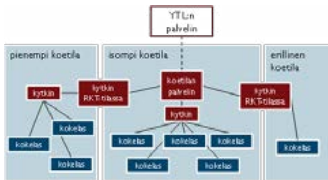
Kuvio 4. Esimerkki tietoliikennejärjestelystä. Punaisella pohjalla olevissa laitteissa on oltava akkuvarmistus. Jos verkkoliikenne kulkee RKT-kaapeissa olevien kytkinten läpi, on nämäkin kytkimet akkuvarmistettava. Sinisellä pohjalla olevissa päätelaitteissa on oma akku. Näihin ei tarvita erillistä akkuvarmistusta. Ulko-verkkoyhteyttä ei tarvitse akkuvarmistaa.
